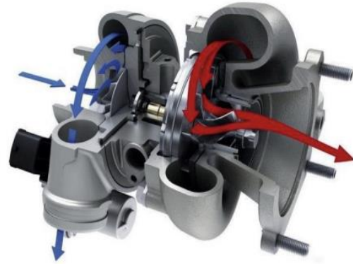
图4：涡轮增压器工作原理示意图
