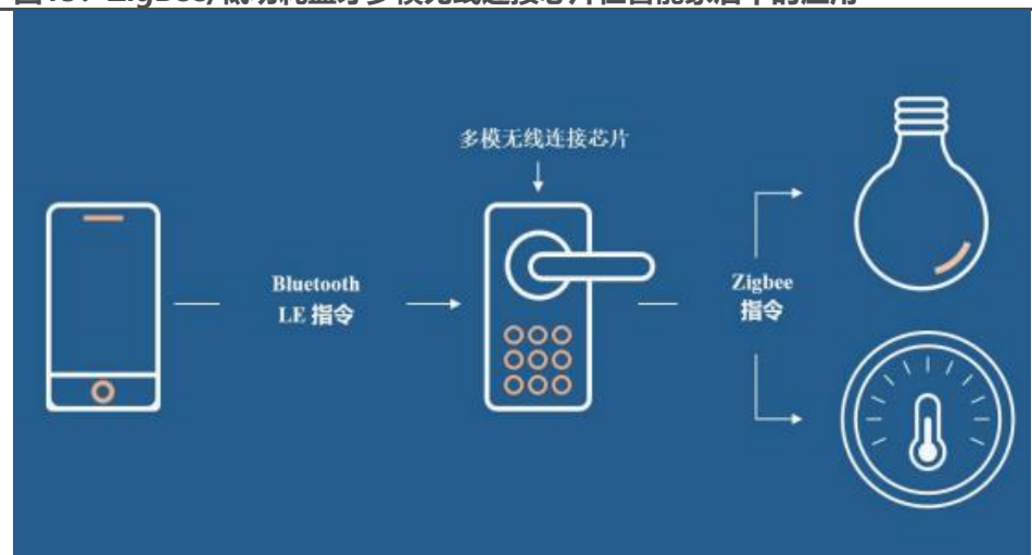
图15：ZigBee/低功耗蓝牙多模无线连接芯片在智能家居中的应用
