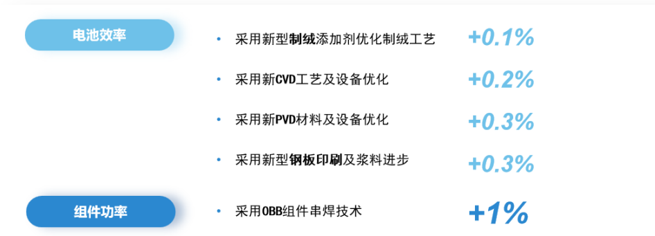
图27: HJT 提效主要体现在优化制绒、CVD、PVD、印刷、OBB 技术五大环节
