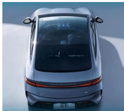
图86：比亚迪海豹搭载 EC 调光+LOW-E 全景天幕
