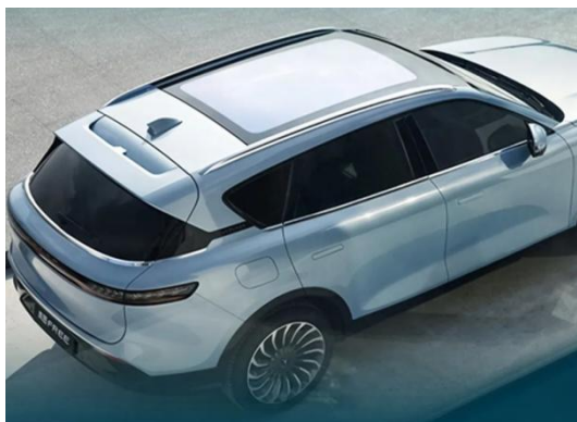
图85：岚图 FREE PDLC 调光+镀膜隔热全景天幕
