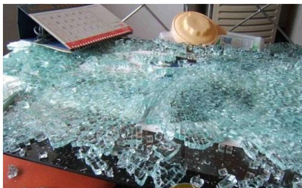
图25：汽车钢化玻璃碎裂成小块，不割伤人
