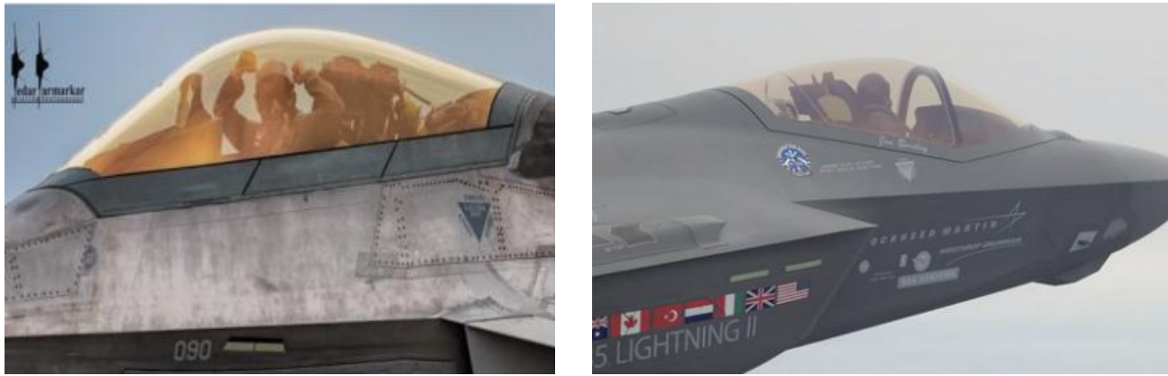
图 42：座舱透明件在美国 F-22（左）和 F-35（右）战斗机上的应用
