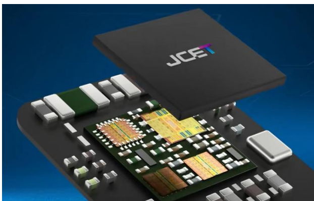
图 37：SiP 技术可以将不同器件封装成一个模块
