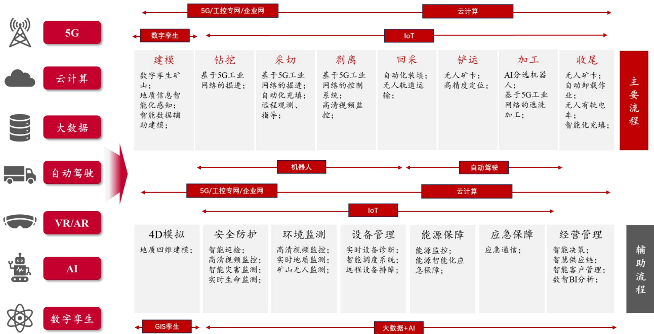
图表 22: 智能化技术覆盖矿山领域的作业流程与辅助流程环节
