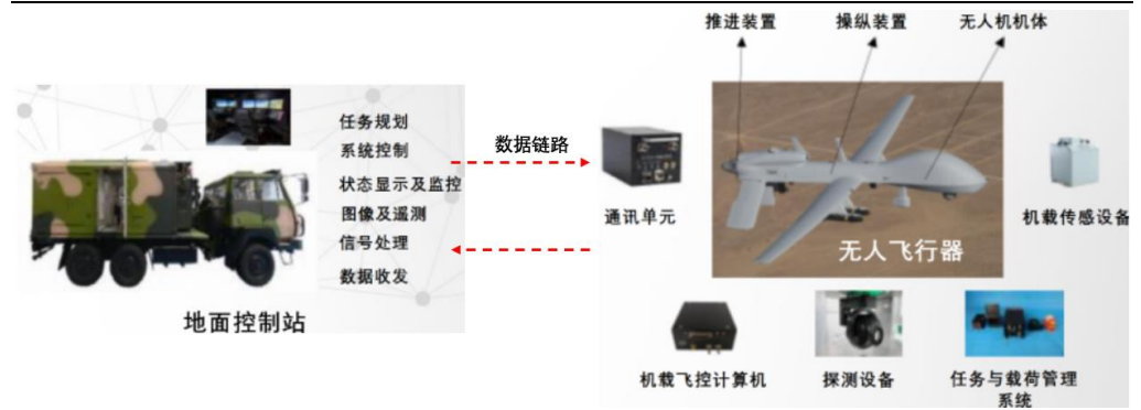
图38: 军用无人机工作机理
