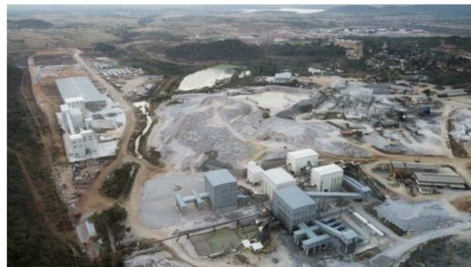
图：公司所属津巴布韦Bikita矿山200万吨/年（透锂长石）重选厂
