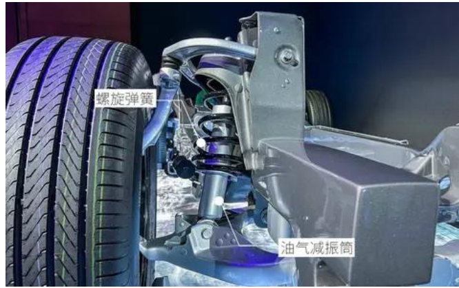
图24：比亚迪仰望U8悬架系统采用螺旋弹簧+油气弹簧的复合弹簧结构
