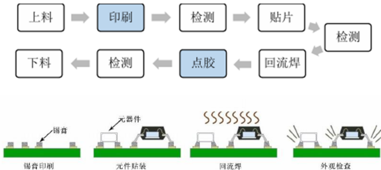
图 13: 表面贴装工艺(SMT)电子装联生产线的主要工序
