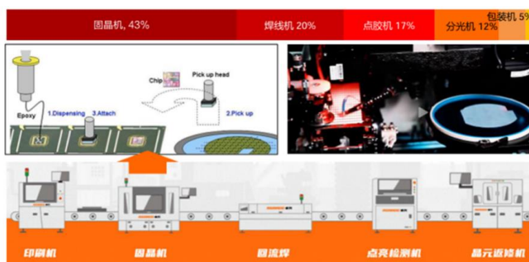
图 21：LED 封装工艺流程与封装设备价值量占比
