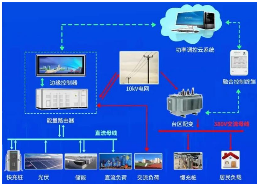
图47：交直流混合微电网结构示意图
