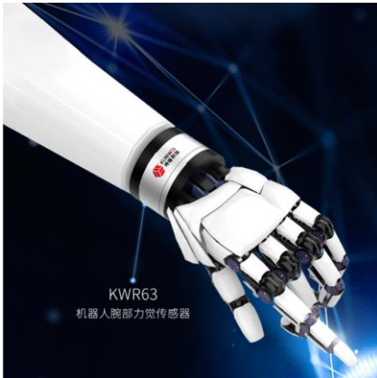
图 9：人形机器人腕部需配备六维力传感器
