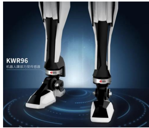
图 10：人形机器人踝部需配备六维力传感器
