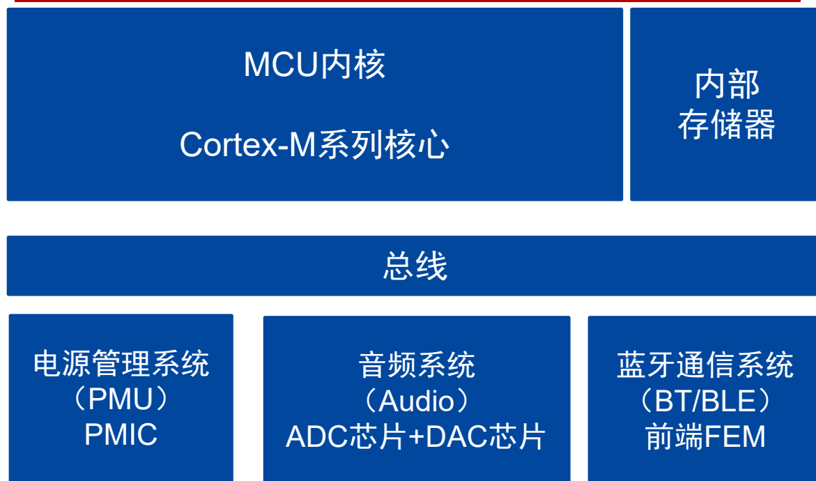
MCU级SoC结构图
