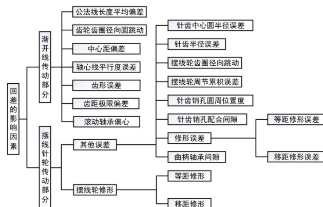
图31: RV 减速器回差影响因素多
