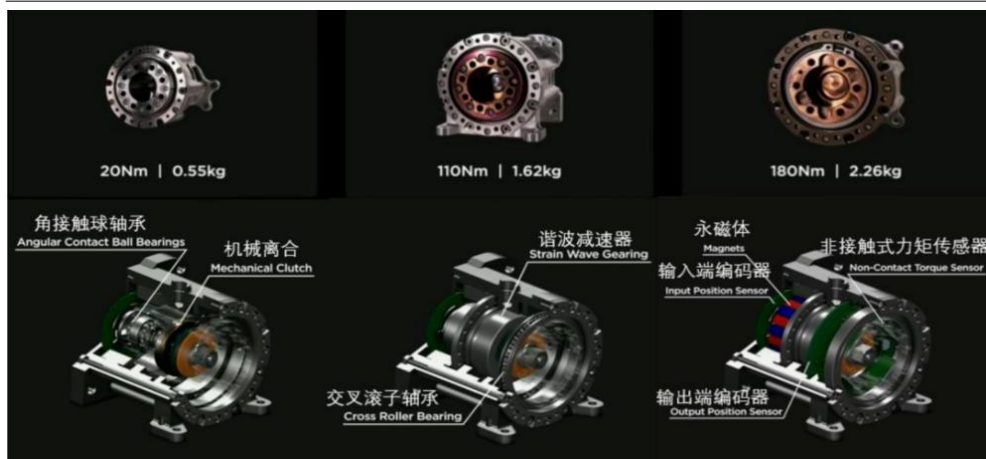
图47: 特斯拉 Optimus 机器人减速器方案
