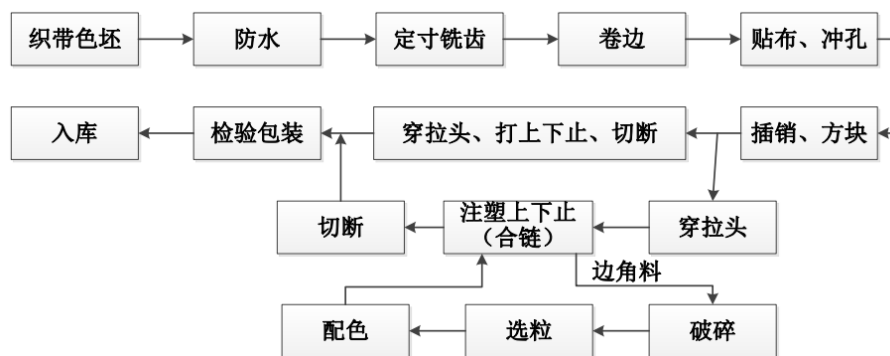
图4: 尼龙拉链、隐形拉链生产工艺流程
