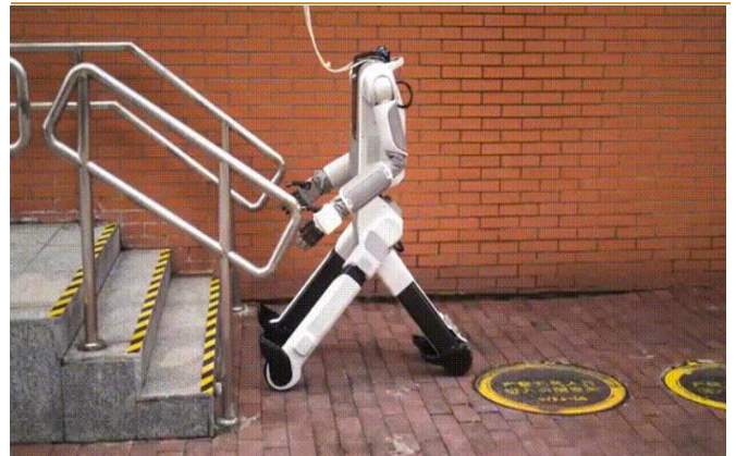
图 8：小五机器人采用四腿轮足复合设计
