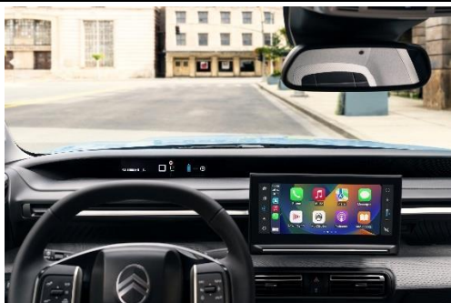
图21: 雪铁龙 E-C3 配备平视显示器和紧凑型方向盘
