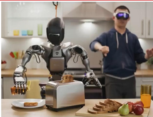
图表22：使用Apple Vision Pro为操作员提供第一人称视角控制的人形机器人
