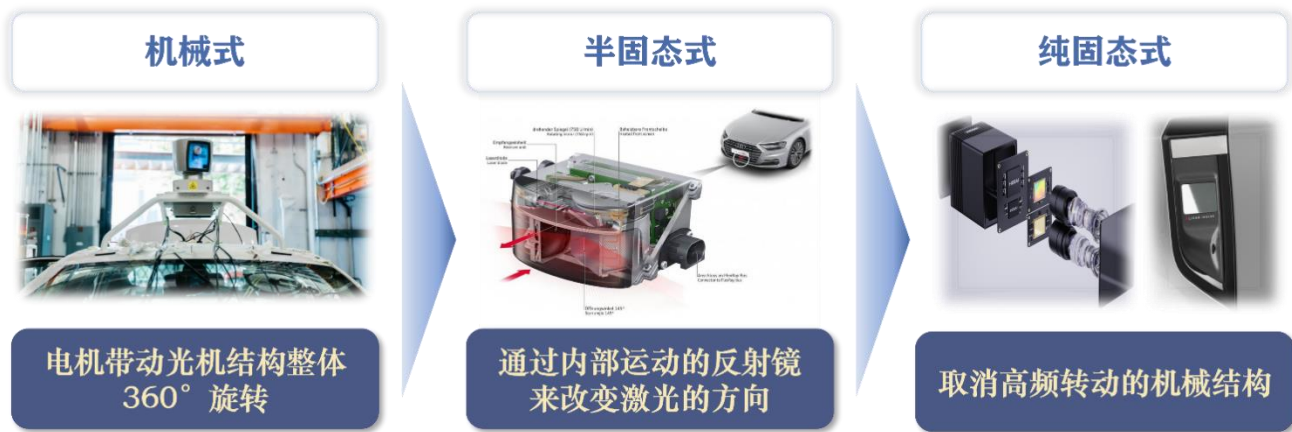
图表8: 车载激光雷达固态化发展趋势
