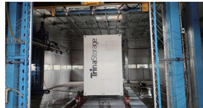
图25 电池舱IPX5防水产品评估IEC 60529测试
