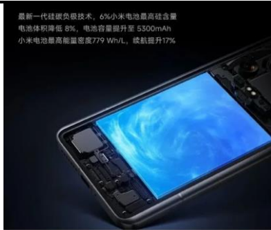
图 27：小米 14 Ultra 采用最新一代硅碳负极技术
