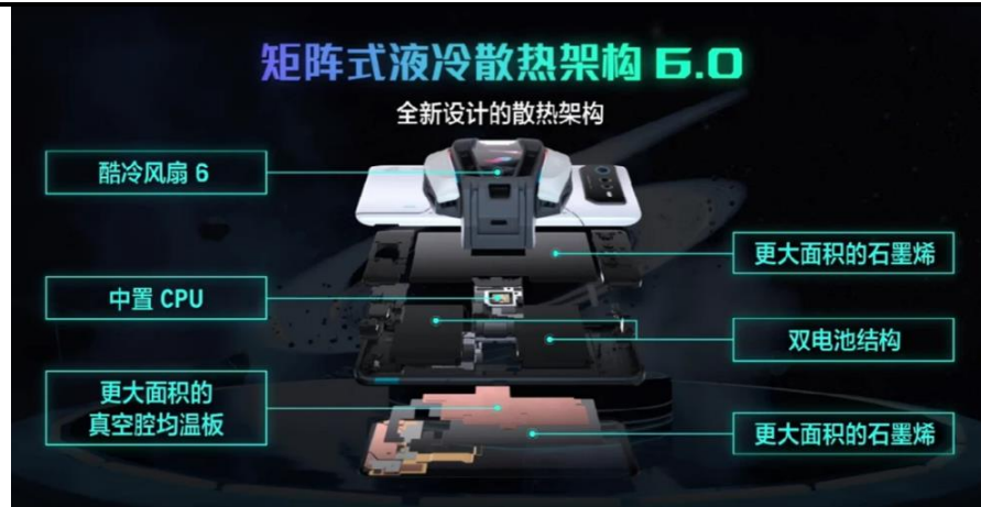
图 26：腾讯 ROG 游戏手机 6 系列矩阵式液冷散热架构示意图
