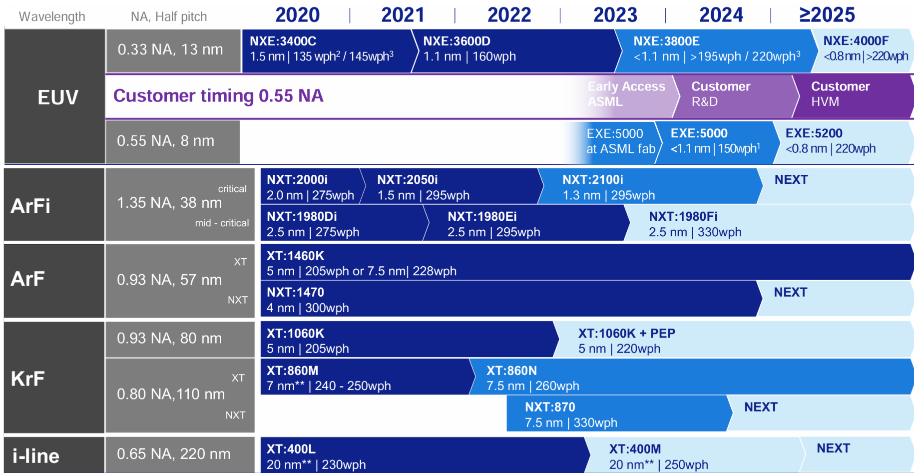
◆ 图：2020-2025年ASML光刻机迭代路线图
