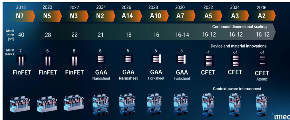
◆ 图：IMEC对逻辑芯片技术迭代路线图的预测
