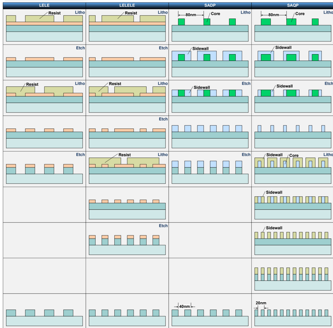
◆ 图：多重曝光技术LELE、LELELE、SADP、SAQP工序示意图
