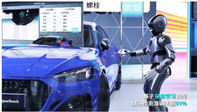
图19: Walker S 系列检测轮胎并实时上传检测结果
