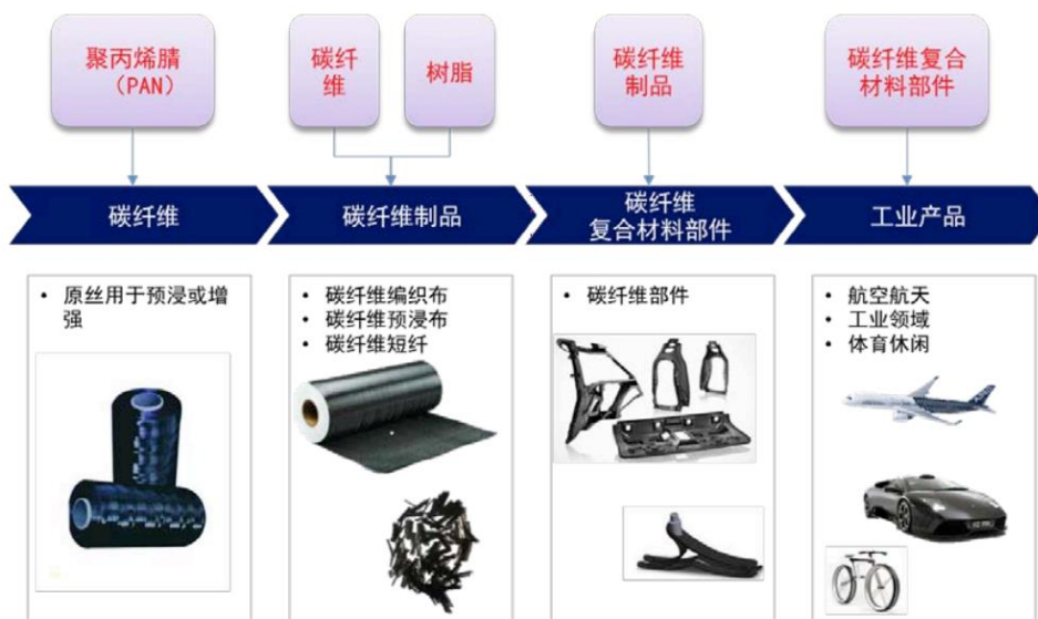
图表24：聚丙烯腈（PAN）基碳纤维复材产业链
