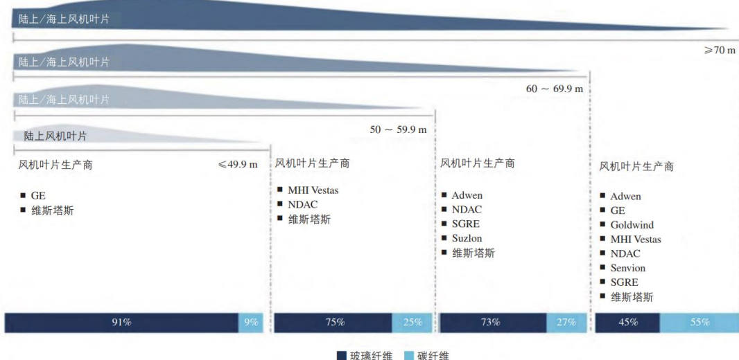
图表18：随叶片长度增加碳纤维主梁叶片的占比变化
