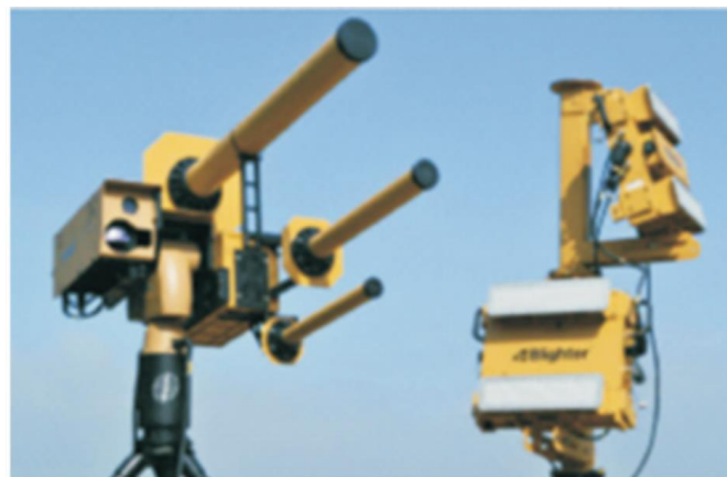
图3 典型反无人装备：“隼盾”电子战系统
