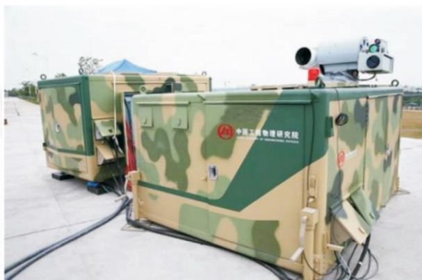
图2 典型反无人装备：“低空卫士”激光防御系统
