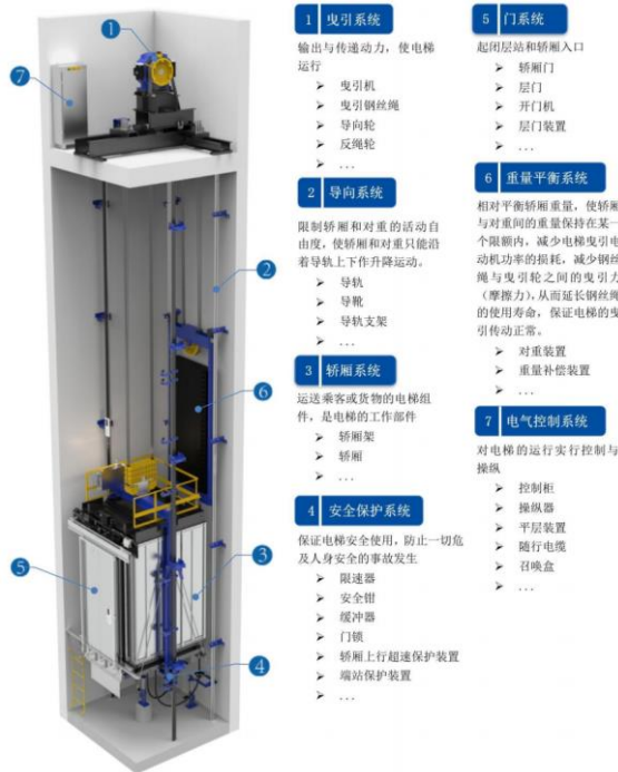
图表2：垂直电梯内部组成结构
