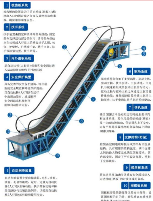
图表3：自动扶梯内部组成结构
