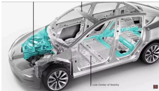
图 62: 特斯拉 Model Y 一体成型车架将原来 70 个零部件合为 2 个大件
