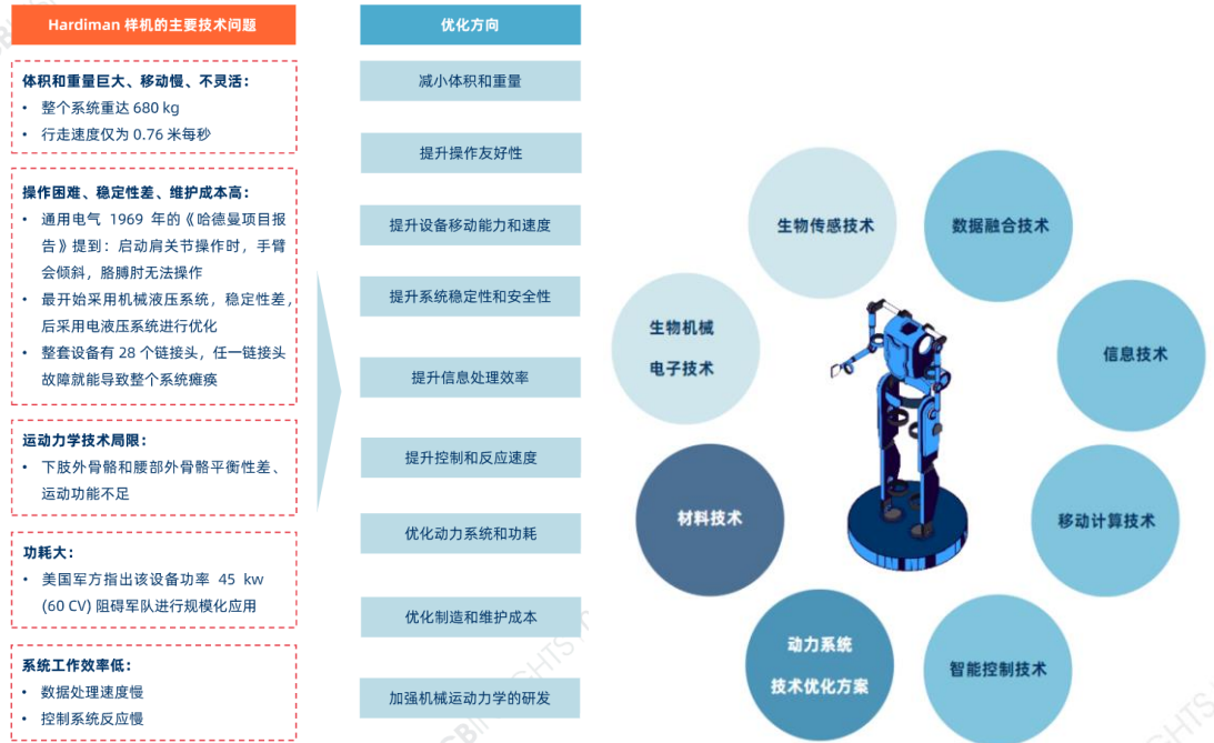
图表 16. Hardiman 项目技术问题映射出的外骨骼技术发展方向
