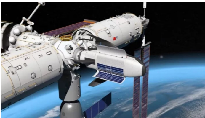
图表21: “昊龙”货运航天飞机示意图
