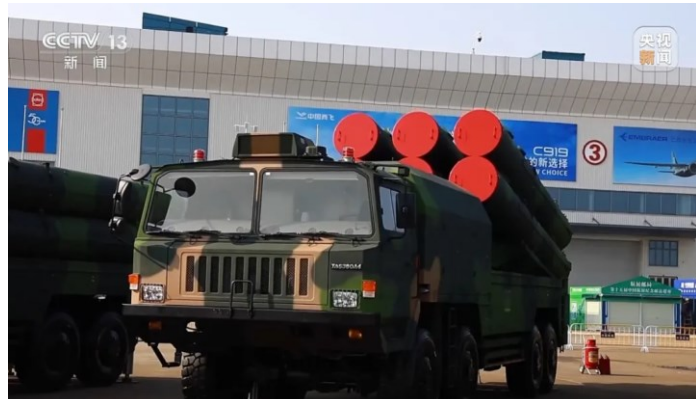
图表14：红旗-19 发射车采用 8×8 轮式高机动卡车底盘
