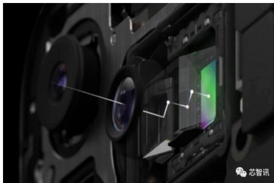
图：iPhone15 Pro Max采用四重反射棱镜
