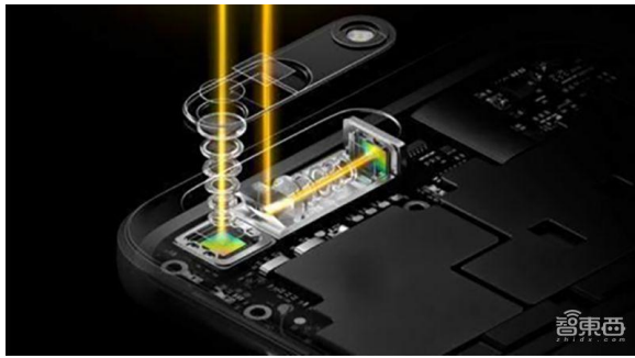
图 49：潜望式镜头结构
