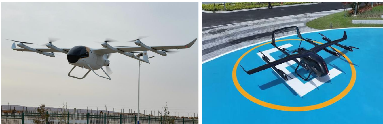
图96：航天飞鹏：FP-981C “射手座” 垂起复合翼无人运输机 (左图)；FP-981A “天秤座” 多旋翼无人运输机 (右图)
