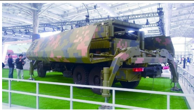
图45：正在变形展开的 YLC-16 型雷达
