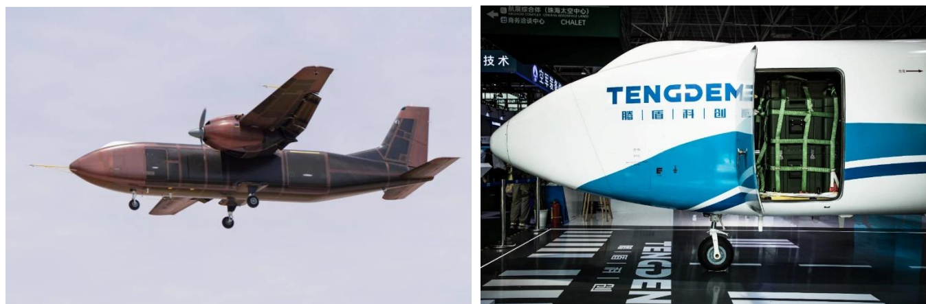
图94: 腾盾科创: 国产大型双发无人运输机及其内部货仓展示
