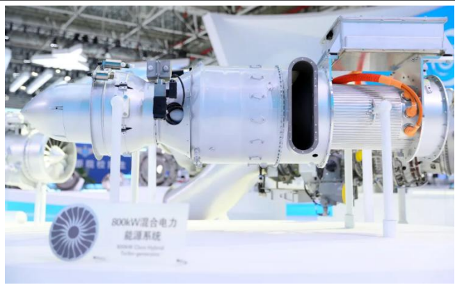
图14：中国航发 800kW 混合电力能源系统
