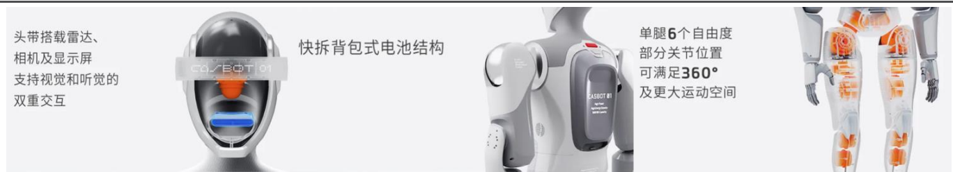
图2：从左至右依次为 CASBOT 01 头部设计、背包式电池结构及腿部电机排布情况
