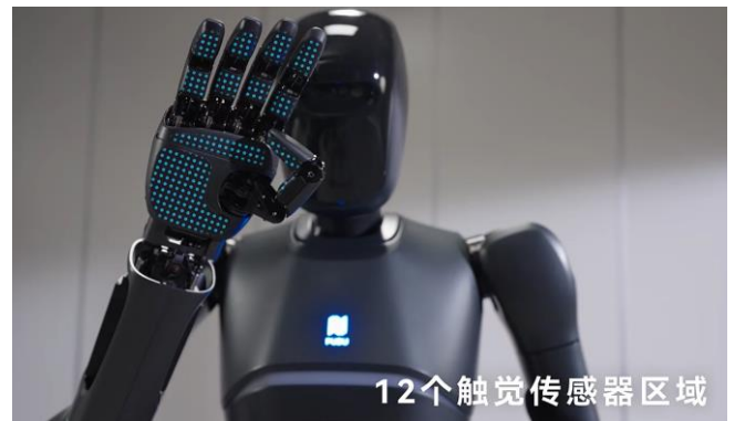
图11: 1018 个感应点分布于 12 个触觉传感器区域
