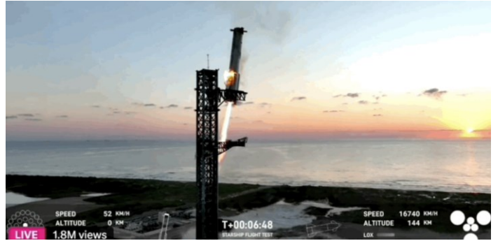
图表79: 发射塔的机械臂成功夹住了返回地面的“星舰”超级重型火箭助推器
