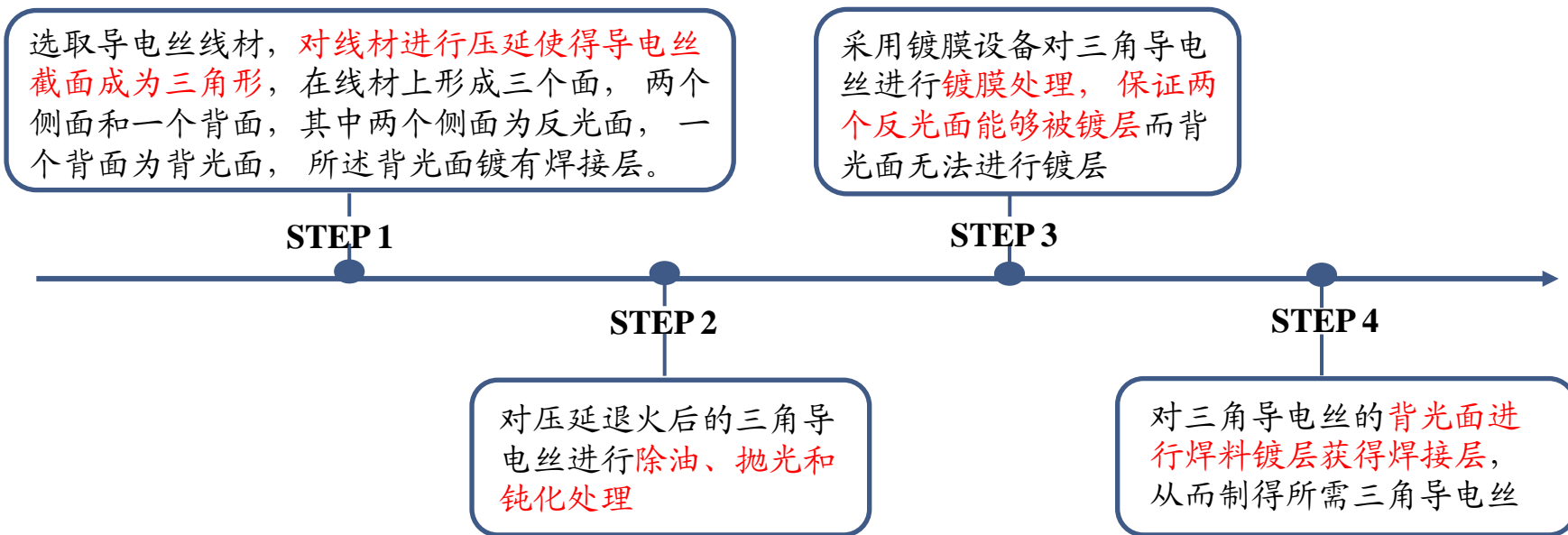
◆ 图：三角导电丝的制备流程
