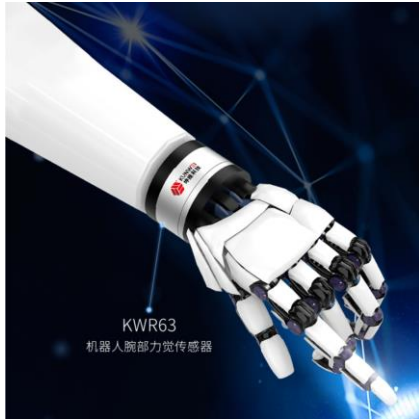
图 10: 人形机器人腕部需配备六维力传感器
