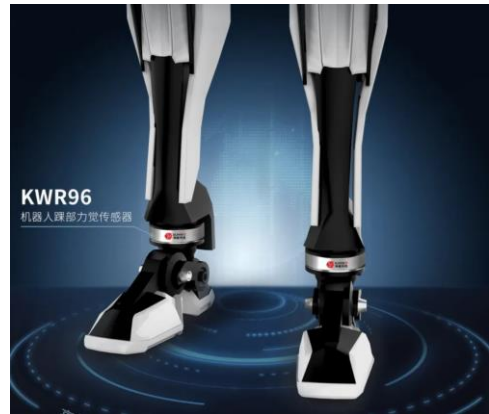
图 11: 人形机器人踝部需配备六维力传感器
