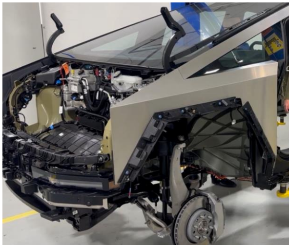
图：特斯拉Cybertruck使用线控转向
