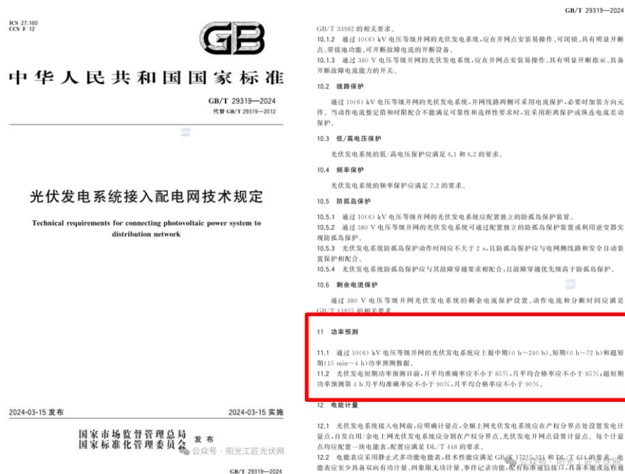
图：功率预测将成为分布式光伏接入配网的重要要求之一
