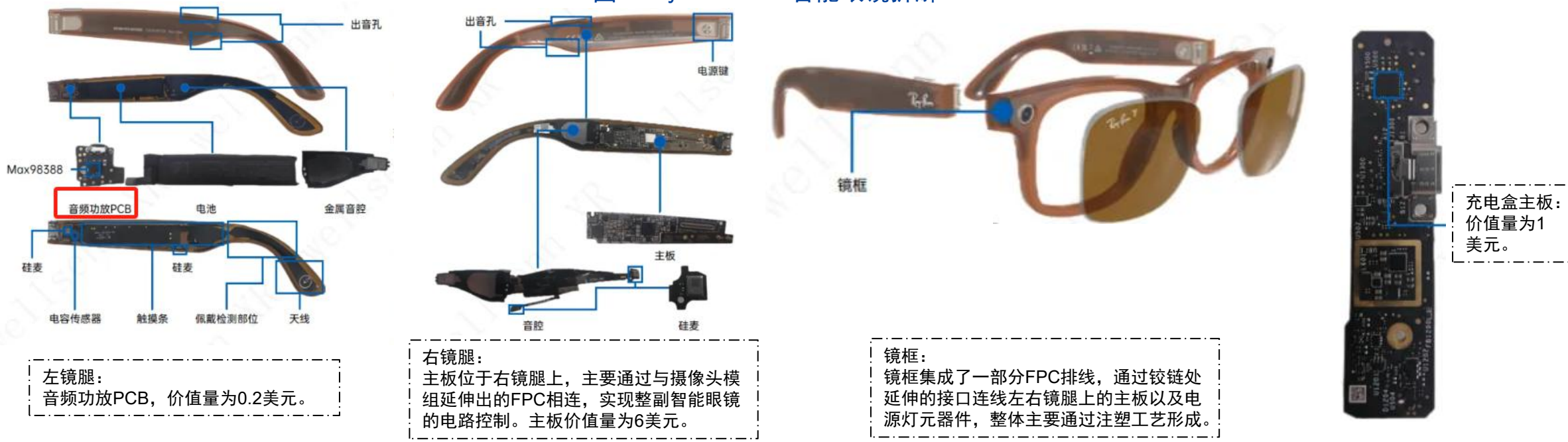
图: Ray Ban Meta智能眼镜拆解
