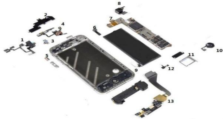
图：智能手机拆解图及FPC具体应用情况
