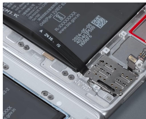
图：Magic V3卡槽（左）和主板（右）实物图
