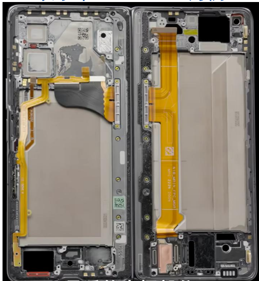
图：折叠机通过大块FPC连接左右两部分的电路（以小米MIX Fold 4为例）
